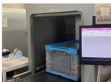
箱に入れたまま個別の商品タグを認識 可能なトンネルゲート式の読み取り設備
