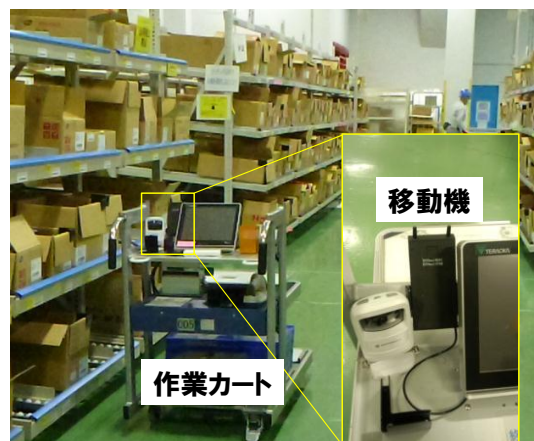
図5 ピッキングカートとその上に取り付けた移動機
